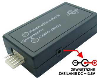
Programator przystosowany do zewnętrznego zasilania
